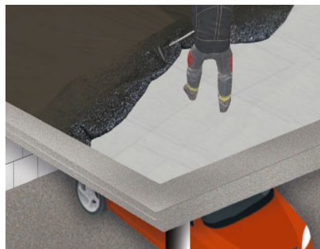
Trag- und Verschleißschicht aus Gussasphalt
